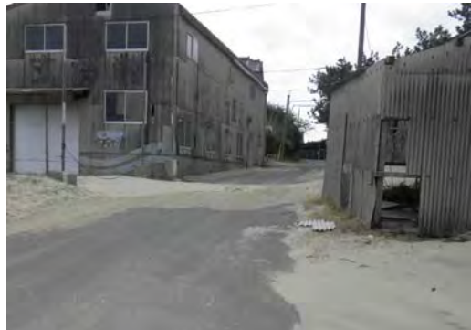
新宮海岸から住宅地に伸びる道路に沿って輸送された飛砂の堆積状況
