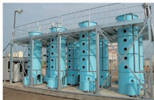
焼却灰脱塩処理装置実証プラント
