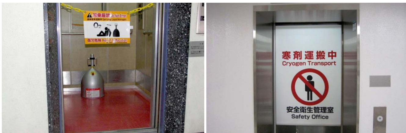
図8 寒剤のエレベータでの運搬例
