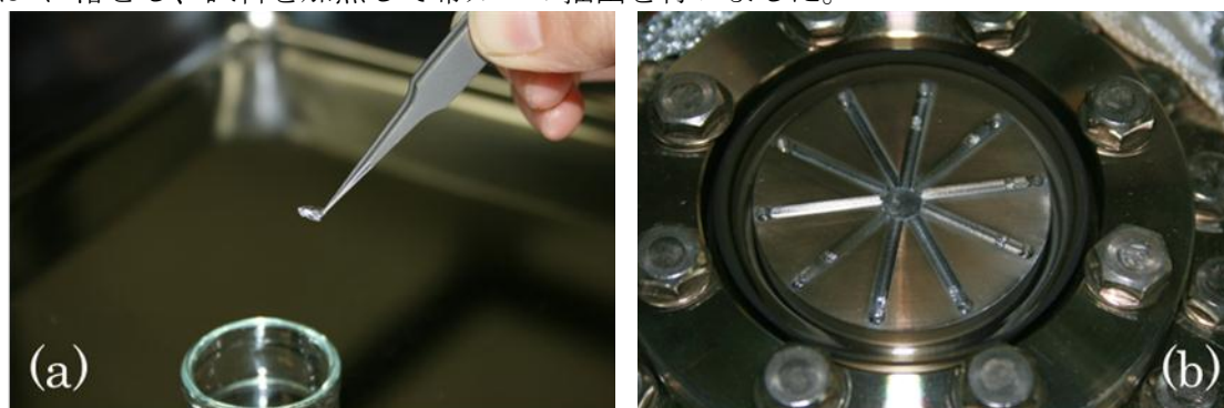
<図 1. アルミ箔カップ(a). 真空加熱炉にセットした試料(b).>
