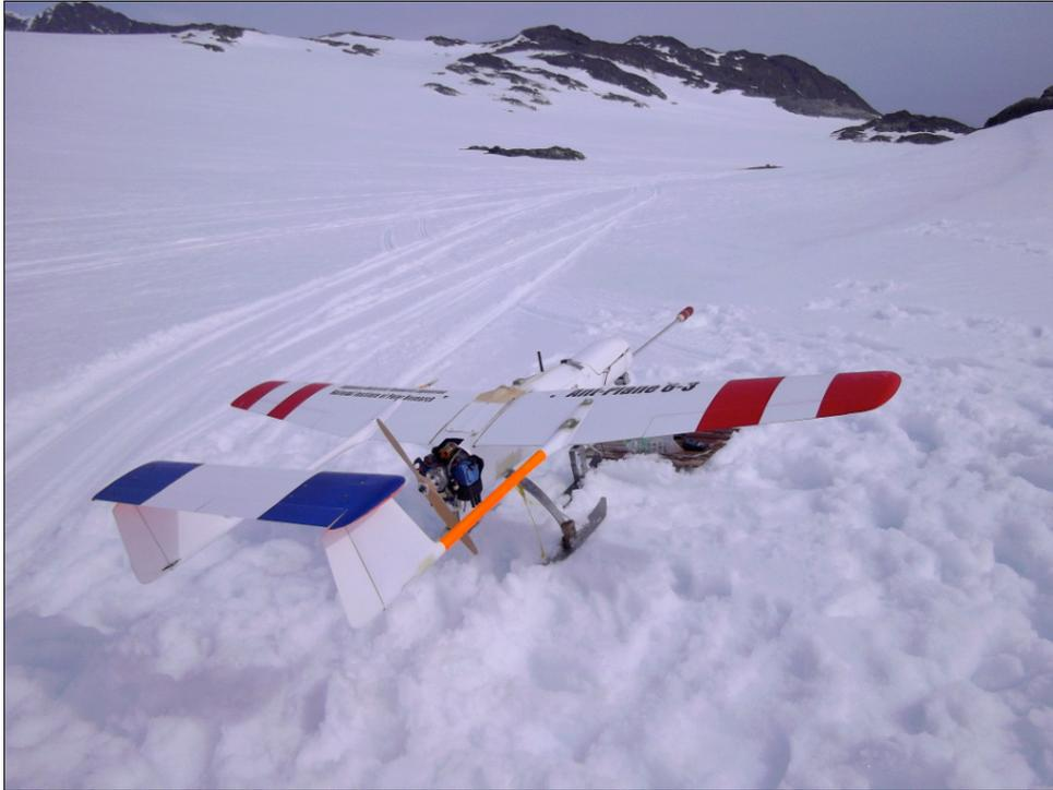
図3. セントクレメント基地の氷河上の Ant-Plane6-3 号機。機体先端に磁力計のセンサーが取り付けられている。
