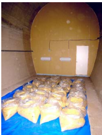
高温空間（家庭用エアコン室内機設置空間）における竹チップの乾燥の様子
