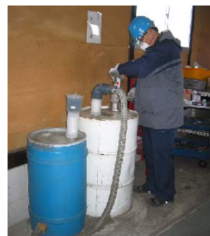
スプレー缶のガス処理
