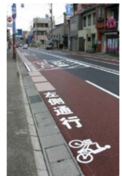
■ 路面表示 (ピクトサイン) の例 (金沢市)
