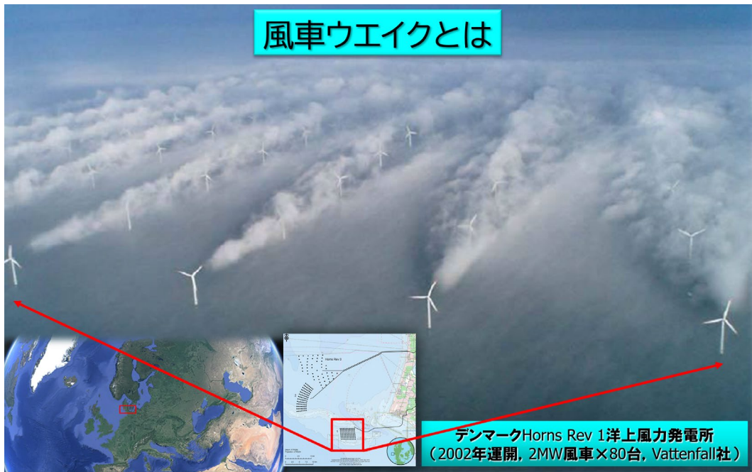
図2 大規模洋上ウィンドファームにおける風車ウエイクの相互干渉の可視化例(実現象)
