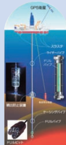
図2 ライザー掘削方式 (提供 JAMSTEC)
