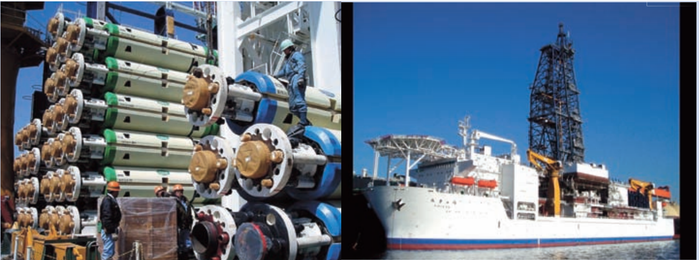
図1（写真左）レーザー管ユニットと（写真右）地球深部探査船「ちきゅう」（提供 JAMSTEC）
