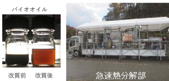
図 3 バイオオイルと可搬型熱分解装置[4]
