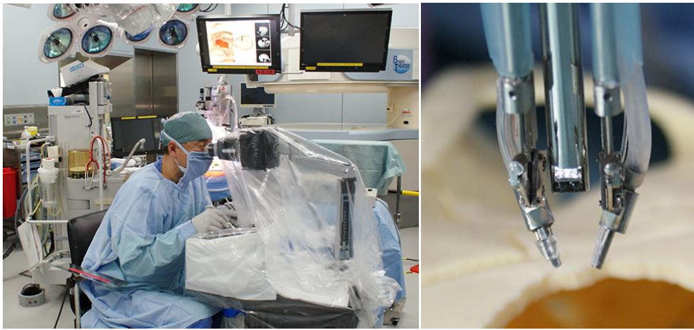
図3 脳神経外科用インテリジェント手術支援ロボット全景と先端処置具部分
