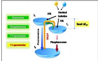
図-1: 非発光性の励起三重項状態(T<sub>1</sub>)を発光性の励起一重項状態(S<sub>1</sub>)へ変換させる発光機構
