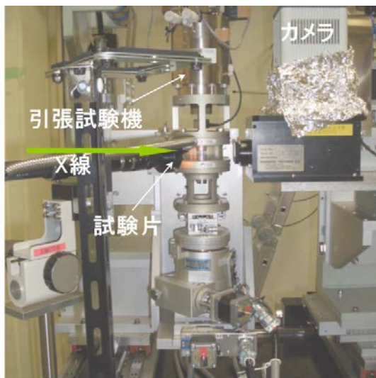
図2 SPring-8 のイメージング用ビームライン BL20XU での実験風景
