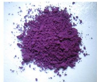
開発した触媒である**ビタミンB<sub>12</sub>担持した高分子粉末**
