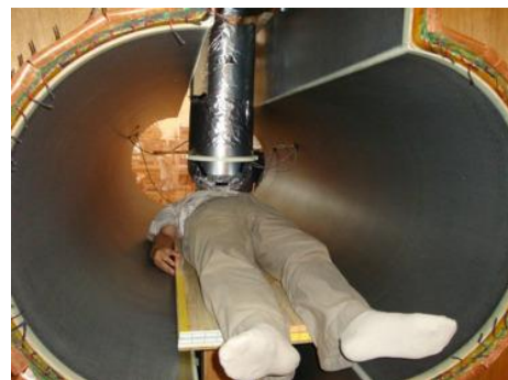
磁気シールド内で被験者の心磁界を計測している様子。両端が解放されているので、MRIのような可動式ベッドで患者を入れることも可能
