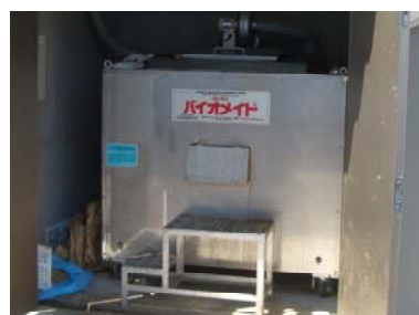
生ゴミ堆肥化装置
