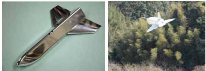
再使用型宇宙往還機の風洞模型(左)と無線操縦による飛行実験(右)
