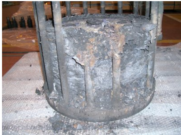
図7 電解セルの完成状態（左）と今回の破損状態（右） （電解セルタンク内に取り付けられた状態では上下が逆になる）
