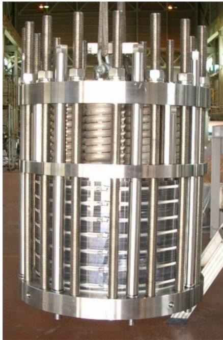
図7 電解セルの完成状態（左）と今回の破損状態（右） （電解セルタンク内に取り付けられた状態では上下が逆になる）
