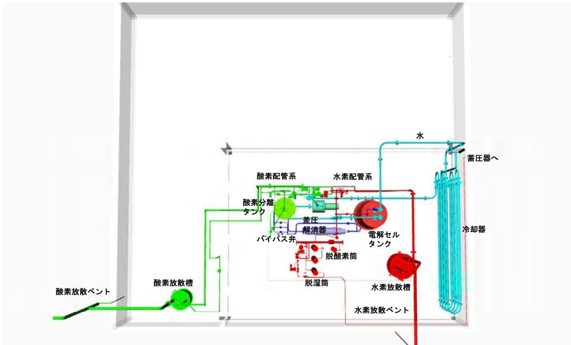
図 A1 上方よりみた HHEG 室と主要機器・配管
