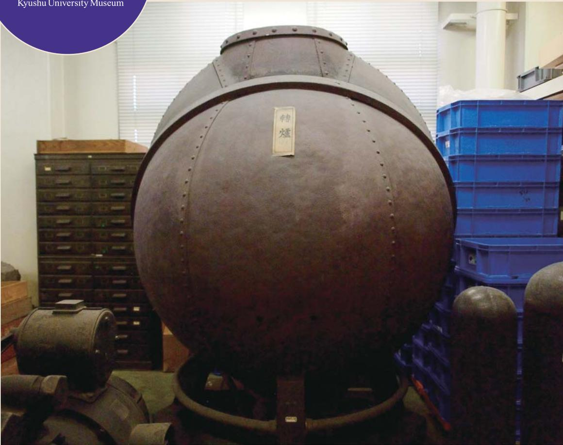
1902年に足尾銅山で試験的に導入された転炉(銅マットから金銀を分離するためのセクター)
