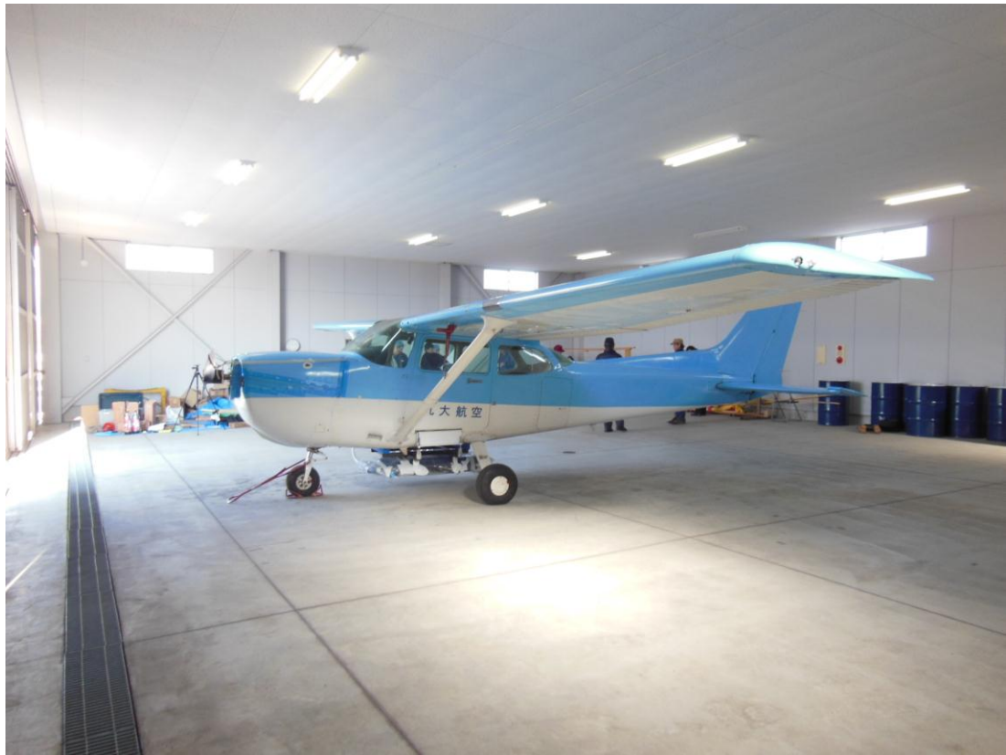
組み立て中の小型電動飛行機
