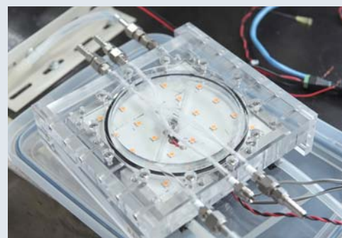
JAXAと共同研究している藻類観察装置
