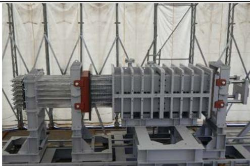
写真1：高圧脱水固化処理装置の全景
