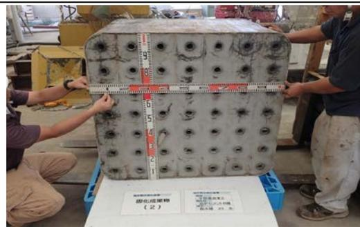
写真2：製造した浚渫土砂ブロック
