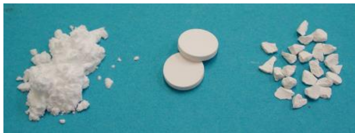
図2.形状の異なる炭酸アパタイト 左から粉末、ブロック、顆粒の炭酸アパタイト。
