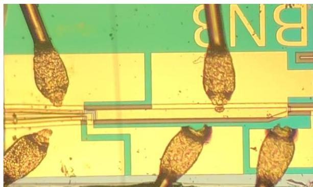
図1: モード選択光源の素子写真。レーザー光の干渉現象が内部(写真中央付近)で生じる新しい半導体レーザー。
