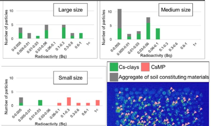
各粒径における放射性粒子の形態を分析した結果、粒径が114 μm未満の画分に
