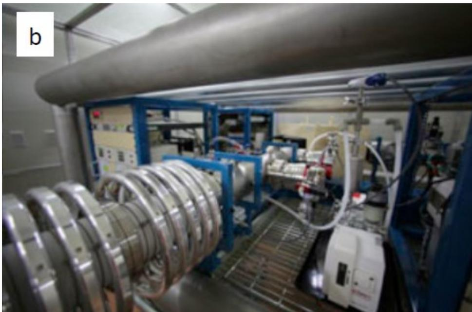
図 4： かつての海水準の時期を決定する放射性炭素年代測定を行う装置。
