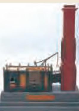
(写真2) パドル炉模型。18世紀に考案され、銑鉄を反射炉で溶融すると同時に鉄の棒で攪拌し脱炭、鍛鉄を得た
