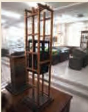
(写真1) 脊坑昇降機。ケーブルが切れた際の
