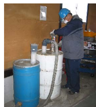
スプレー缶のガス処理
