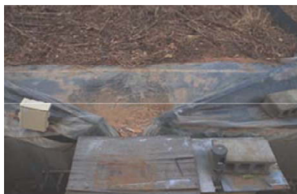
生流れてきた土壌を下端で受けて測定
