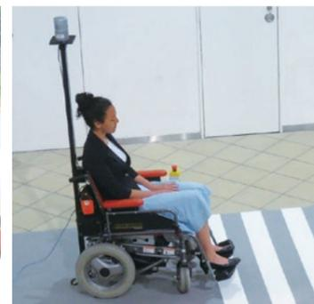
5Gを用いた全周レーザーセンサーによる車いすロボットの誘導実験
