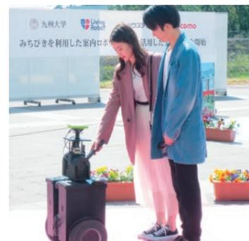
みちびき(準天頂衛星システム)を利用した案内ロボットによる園内案内実験
