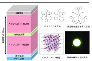
(参考図) 有機発光層として高い発光効率を示す イリジウム化合物や熱活性化遅延蛍光化合物※2を 用いました。その両端に、電気を流しやすく透明 な金属ハライドペロブスカイト層を設置しまし た。従来の有機 EL よりも 10 倍以上厚いにもかか わらず、最大で 40%の極めて高い外部量子効率\*\*3 が得られました。また、ペロブスカイト層の膜厚 を調整することにより、発光スペクトルの角度依 存性を完全に消失させることに成功しました。斜 めから見ても色味が変化しない高性能ディスプレ イを作製するために必要不可欠な技術です。
