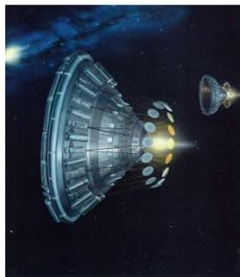
レーザー核融合ロケット VISTA の概図。米国リバモア研設計(2003年)。レーザーを用いた核融合反応で生じる高エネルギープラズマを磁場で右向きに排出している概念図(矢沢サイエンスオフィス提供)。このロケットでは、レーザーを照射することで燃料を爆縮して核融合を引き起こすと同時に、ロケットの推進剤をプラズマ化し、強力な磁場によってロケット外へ排出することで推力を得ます。
