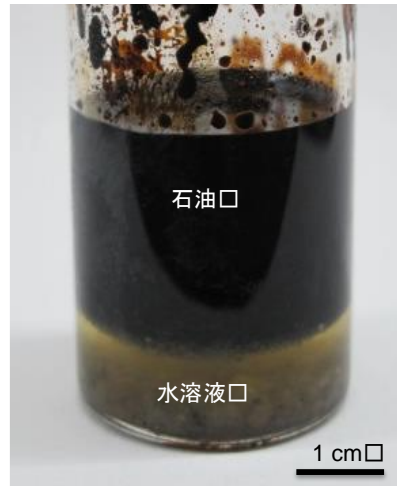
図 1. 反応容器で模擬星間有機物を 400°C に加熱した実験で回収された石油と水溶液
