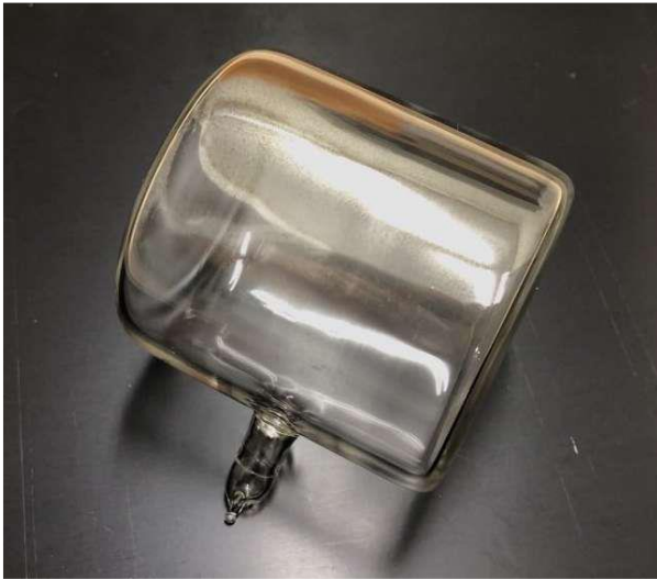
図 2 : J-PARC で開発に成功した ^3\text{He} スピンフィルター。特殊なガラス容器の中に ^3\text{He} とアルカリ金属が封入されている。このガラス容器に近赤外光レーザーを照射し、アルカリ金属のスピンを揃え、アルカリ金属が ^3\text{He} 原子核とスピンを交換することにより、 ^3\text{He} 原子核のスピンを揃えることができる。
