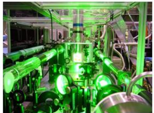
図1：量研関西研にあるペタワット級レーザーJ-KARENシステム。世界最高級の集光強度を誇る。
