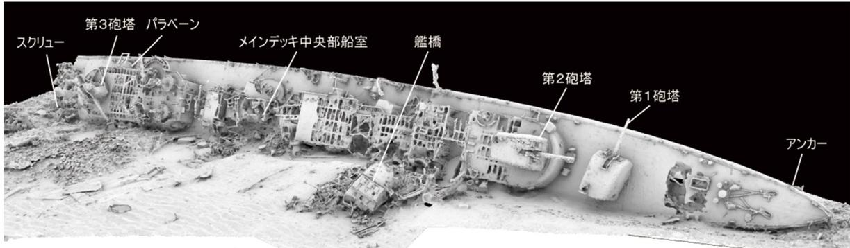
フォトグラメトリを用いて作成したエモンズの3Dモデル
