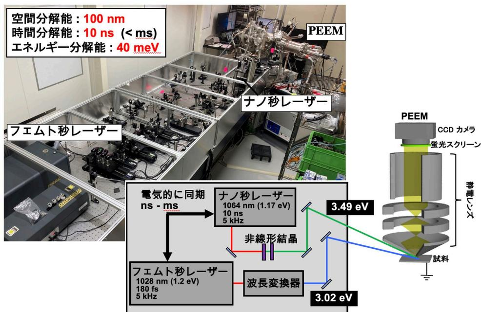
図1 時間分解光電子顕微鏡 (TR-PEEM) の概略図
