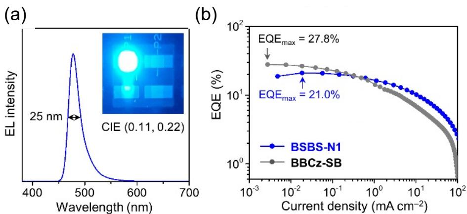
(図2) (a) BSBS-N1を用いた有機ELデバイスのELスペクトルとEL発光の様子
