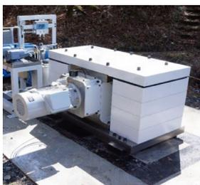
図 1. 小型連続震源装置の写真。約 1m の大きさ。連続的に発振した振動を足し合わせることで、シグナルを強調できる。
