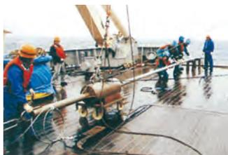
ベーリング海の海底堆積物を全長15mのピストンコアにより採取、過去から現在までの地球環境変動を明らかにする。
