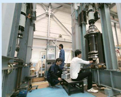
大型円筒部材の疲労強度試験
