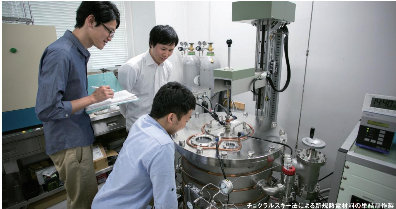
チョクリルスキー法による新規熱電材料の単結晶作製
