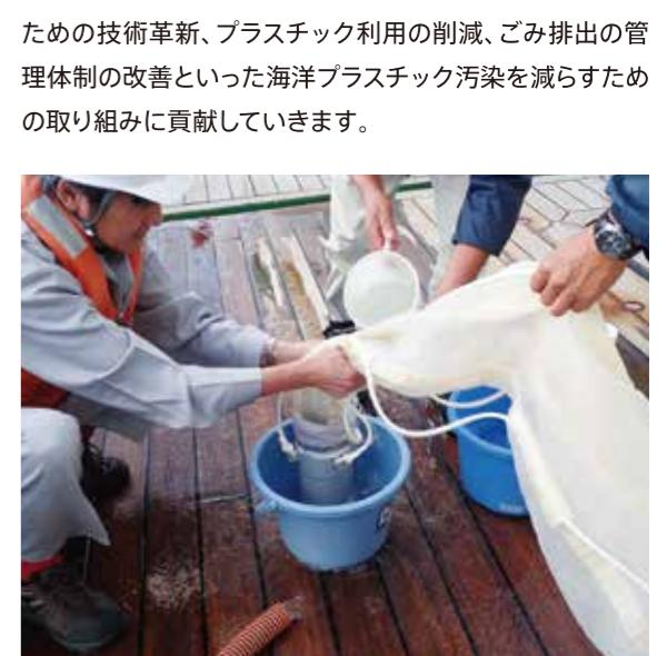
▲ 太平洋観測での浮遊マイクロプラスチック採取の様子
