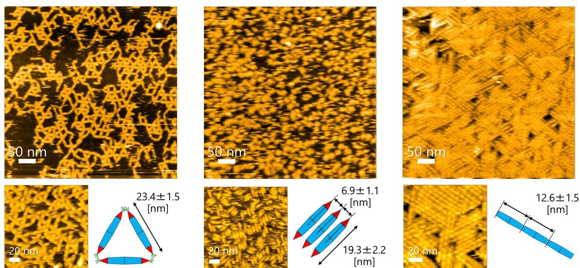
図3. 高速原子間力顕微鏡による、設計PNの二次元ナノ模様観察結果
