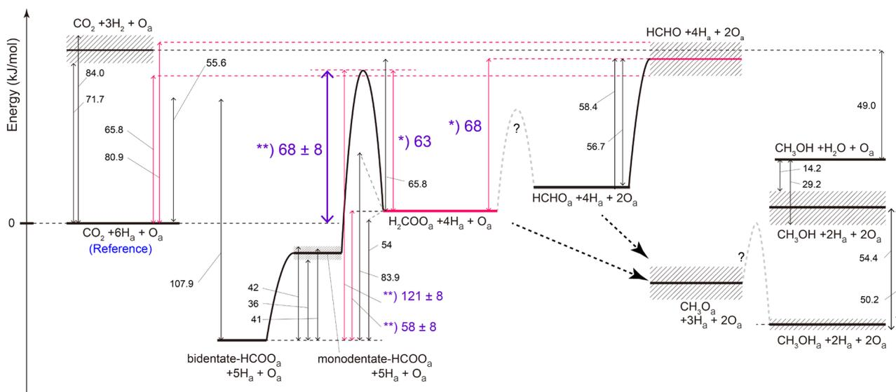
図2 本研究で得た  $\text{CO}_2$  の水素化によるメタノール合成のエネルギーダイアグラム。紫字が今回の結果から解析した各種活性化エネルギーに対応し、その他の数値は文献値を表す。 $\text{HCOO}_a + \text{H}_a \rightarrow \text{H}_2\text{COO}_a$  の活性化エネルギー  $121 \pm 8 \text{ kJ/mol}$  が最も高く、反応が進行する定常状態ではメタノール合成全体の見かけの活性  $68 \pm 8 \text{ kJ/mol}$  となり、銅粉体触媒上の値と合致することが分かった。
