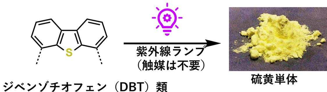
難脱硫性のジベンゾチオフェン類の紫外線による分解と硫黄単体の析出
