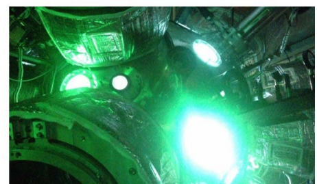
図 3. 激光 XII 号レーザーレーザー照射時の実験チャンバー。アルミとレーザーの相互作用で生じた放射光をとらえている。この放射光が周囲の窒素ガスを瞬時にプラズマ化する。
