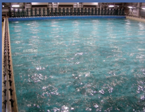
▲プランジャー型造波装置による造波の様子
