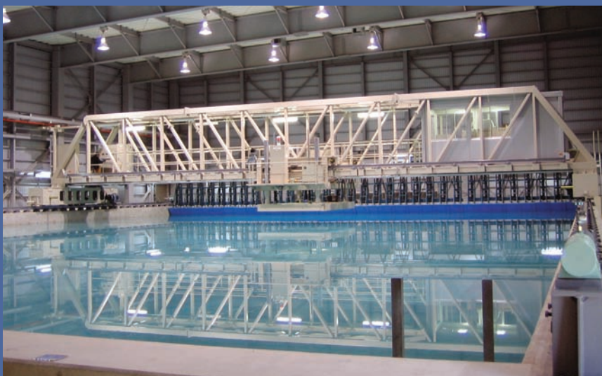
▶船舶運動性能試験水槽本体と 模型曳引車
