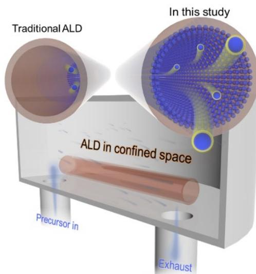
図 1：狭窄空間内への均一な原子層堆積装置。
