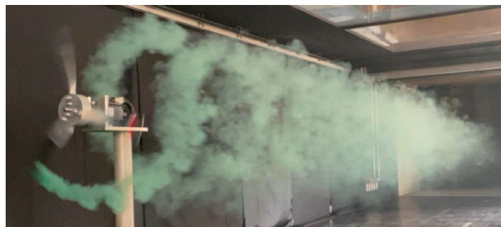
大型風洞設備を用いた風車ウエイク現象の可視化事例
