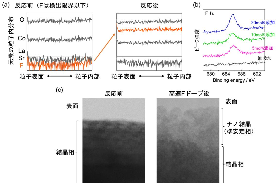
図 2. (a) 粒子内部の元素分布 (TOF-SIMS により計測)。本技術により粒子内部までフッ素を注入できることを実証した。(b) F 1s XPS スペクトルより、F 供給量に応じて F 量が増加していることを確認した (電流密度 300  $\mu\text{A/g}$  にてドーピング)。(c) 大電圧処理による表面ナノ結晶領域の電子顕微鏡像。電流を制御することで自在にナノ結晶を合成することができる。
