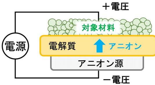
印加電圧によりマイナス電荷のアニオンを駆動し、対象材料に添加
